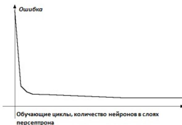
Рис. 6. Зависимость величины ошибки от количества обучающих циклов и количества нейронов в скрытых слоях персептрона
