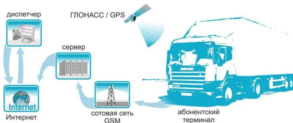
Рис. 2. Схема взаимодействия различных элементов системы отслеживания транспорта
