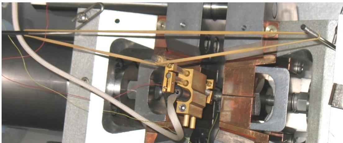
**Рис. 7.** Установка индукционного датчика
