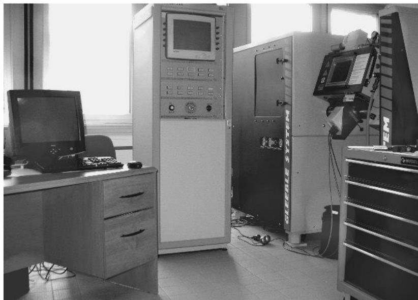
Рис. 5. Установка Gleeble-3500
