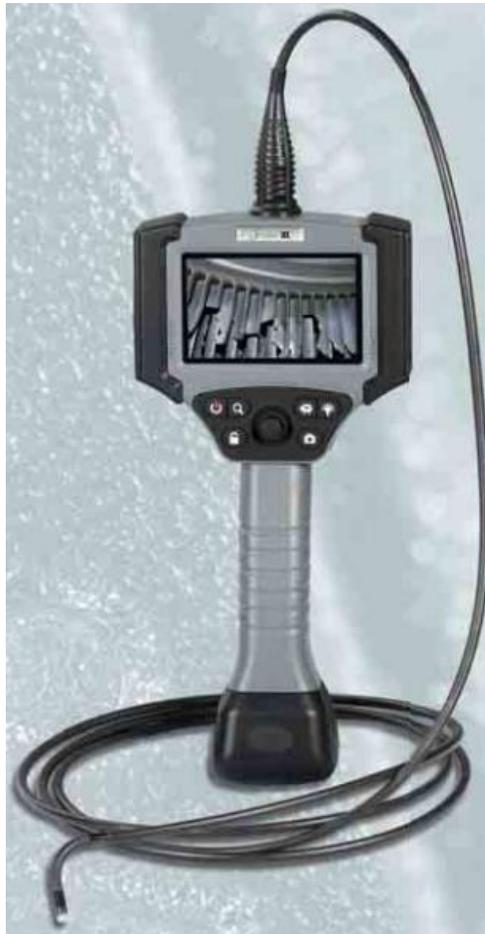
Рис. 8. Цифровой видеэндоскоп
