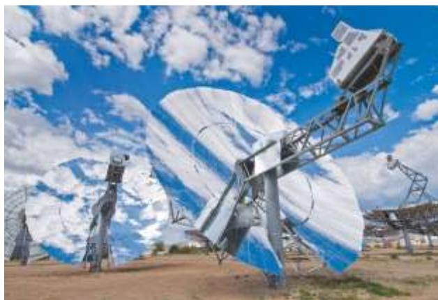
**Рис. 4.** Гелио- электрогенератор с двигателем Стирлинга [4]
