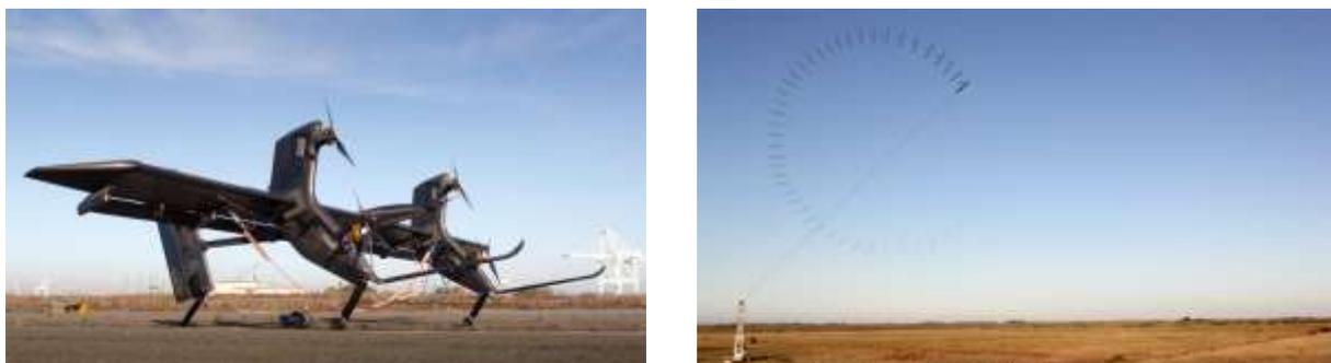
Рис. 2. Ветрогенератор – «летающее крыло» Wing 7 [2]
