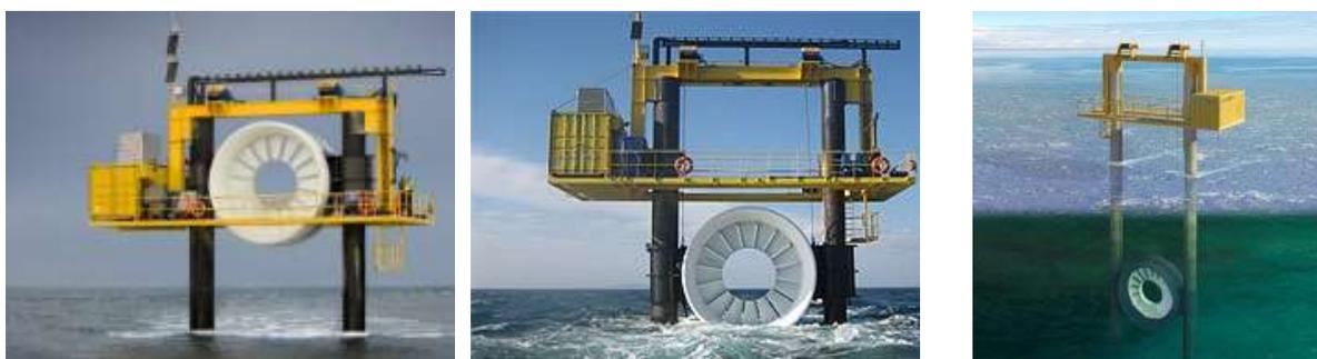
**Рис. 5.** Установка приливной турбины на морское дно [5]
