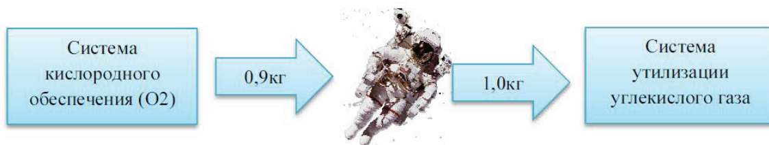
Рис. 2. Суточный CO 2 -O 2 баланс одного члена экипажа
