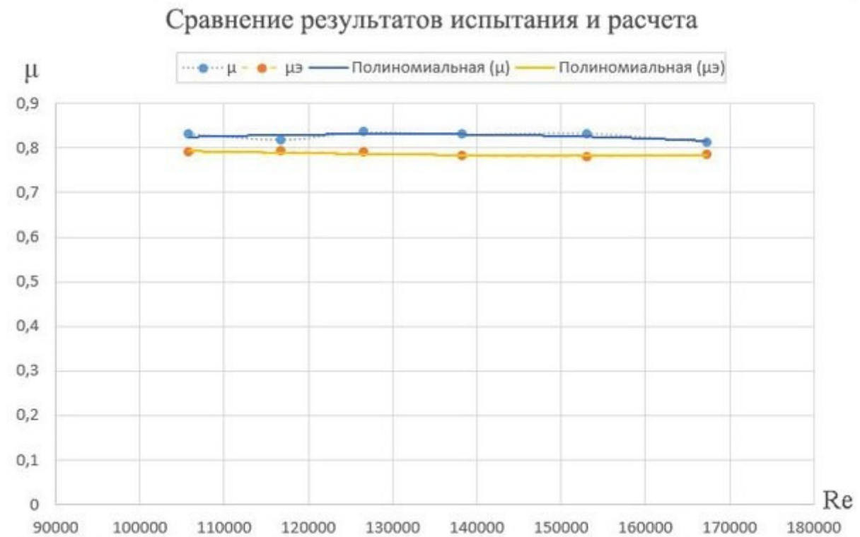
Рис. 7. Сравнение результатов испытания и расчета по коэффициенту расхода
