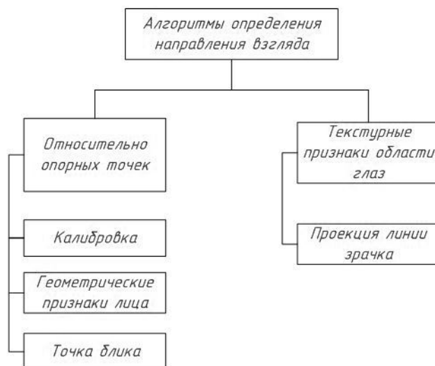
Рис. 2. Классификация алгоритмов определения направления взгляда
