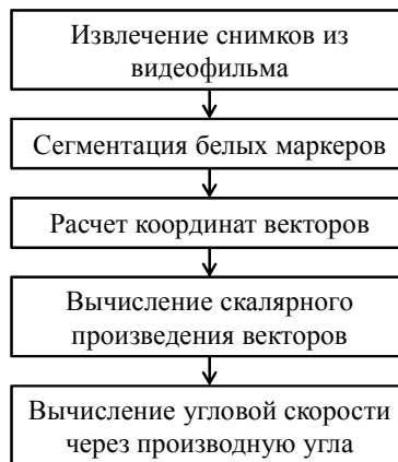
Рис. 6. Алгоритм обработки видеозаписи ходьбы человека
