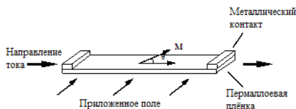
Рис. 1. Принцип действия магниторезистивного датчика
